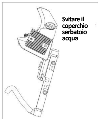
Figura 33 Aggiunta di liquido di raffreddamento
