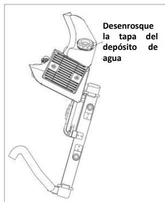
Figura 33 Adición de refrigerante
